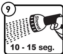
9 Comenzando en la parte inferior del pendiente, rápidamente rociar una sección\*\* de 100 pies cuadrados para fraguar la arena (**de 10 a 15 segundos**).
