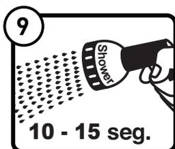
9 Comenzando en la parte inferior del pendiente, rápidamente rociar una sección\*\* de 200 pies cuadrados para fraguar la arena (**de 10 a 15 segundos**).
